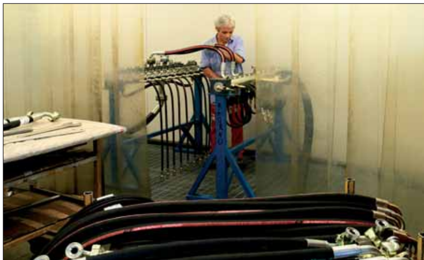
■ Il reparto di flussaggio dei tubi flessibili: la pulizia interna dei tubi ne aumenta la durata
