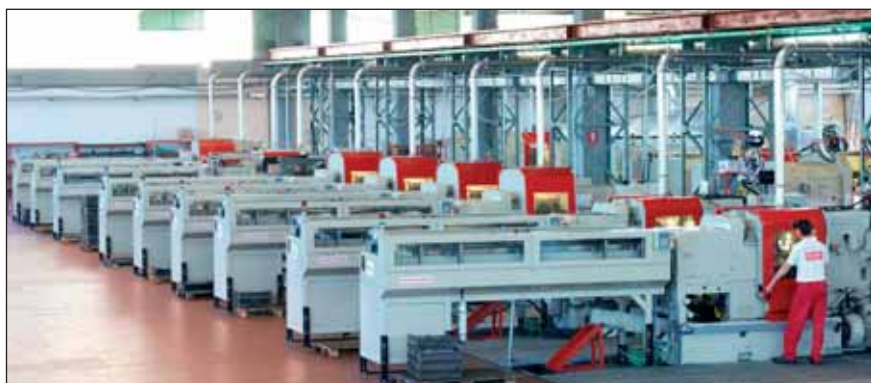
■ La torneria Otap di Pavia. Nell'immagine, i torni plurimandrino
