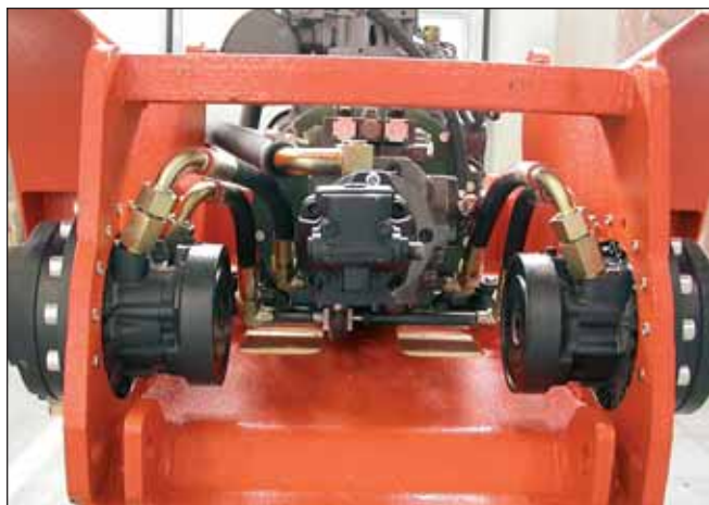
■ Trasmissione idrostatica. Esempi di applicazione su carrello elevatore
