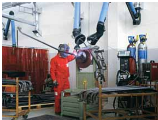
Il processo di saldatura Olmark è conforme ai metodi standard di saldobrasatura ossiacetilenica o con sistemi TIG.
