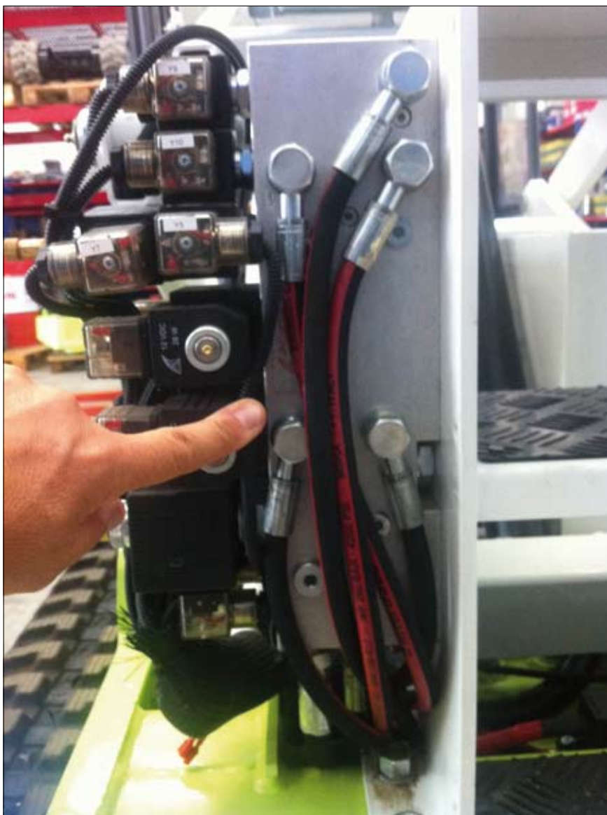
Manifold – Esempio numero 1. Situazione iniziale: collegamento tubazioni flessibili. Esigenza commissionata: semplificare e ridurre il tempo di montaggio, ridurre i tempi di gestione e costo
