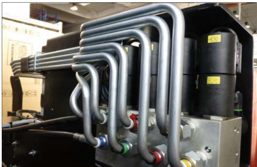
Manifold – Esempio numero 2. Soluzione Oleomarket: raggruppamento a unico fascio di tubi per semplificazione montaggio e identificazione colore per immediata sequenza di collegamento
