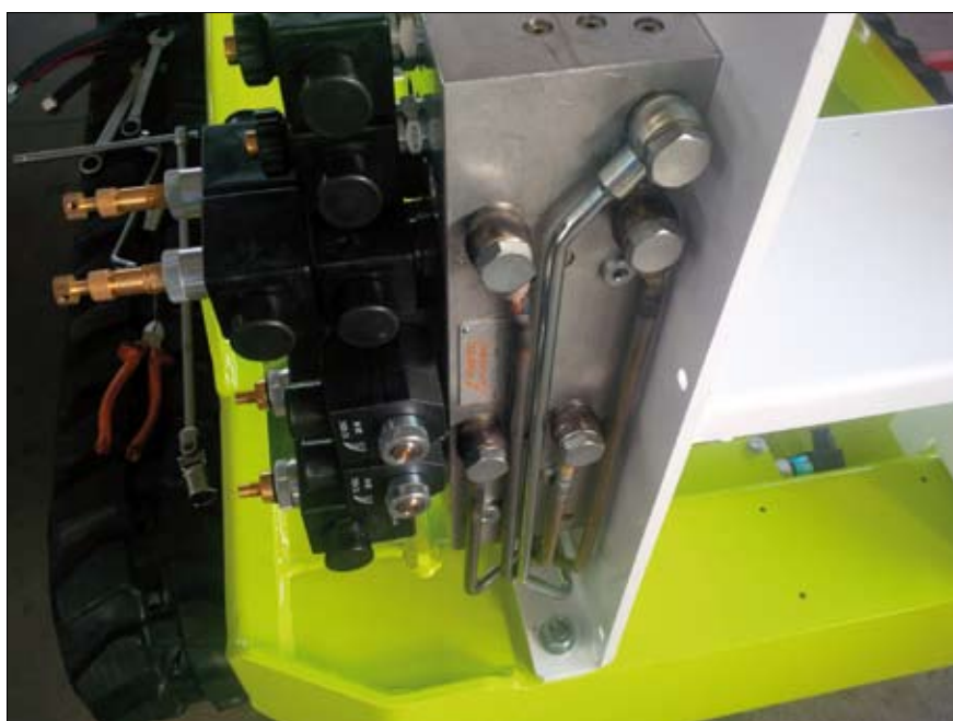
Manifold – Esempio numero 1. Situazione iniziale: collegamento tubazioni flessibili. Esigenza commissionata: semplificare e ridurre il tempo di montaggio, ridurre i tempi di gestione e costo
