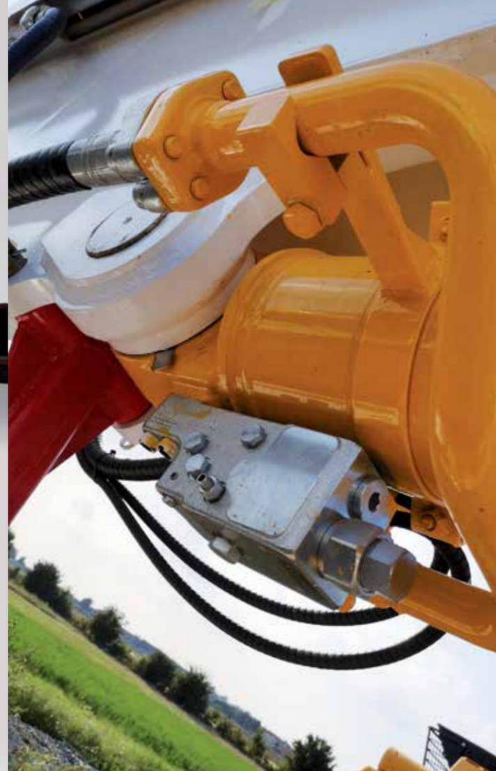
**TUBI RIGIDI SAGOMATI** forniti da Oleomarket a Laurini per i bracci delle macchine speciali da demolizione (nelle immagini a sinistra). Da più di 40 anni, Oleomarket progetta e costruisce raccorderia, tubi rigidi sagomati e tubi flessibili raccordati di alta qualità tecnologica.
