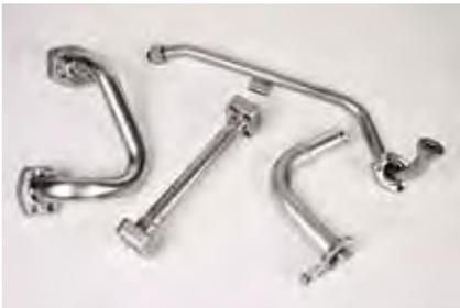
^ TUBAZIONI RIGIDE SAGOMATE A DISEGNO O CAMPIONE CLIENTE SONO FORNITE DA OLEOMARKET FINO A GRANDI DIAMETRI E SPESSORE IMPORTANTI E SONO EQUIPAGGIATE CON FLANGE SAE O SPECIALI, SALDATE CON PROCEDURA TIG CONTROLLATA E CERTIFICATA. SONO INCLUSI IL COLLAUDO FINALE, IL FLUSSAGGIO PARTICELLARE E IL SUCCESSIVO TRATTAMENTO SUPERFICIALE PROTETTIVO
